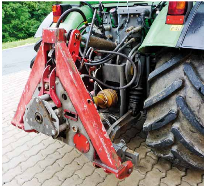
Ce triangle automatique d'attelage permet d'atteler les tracteurs aux engins sans descendre de la cabine. (Photos DR)
