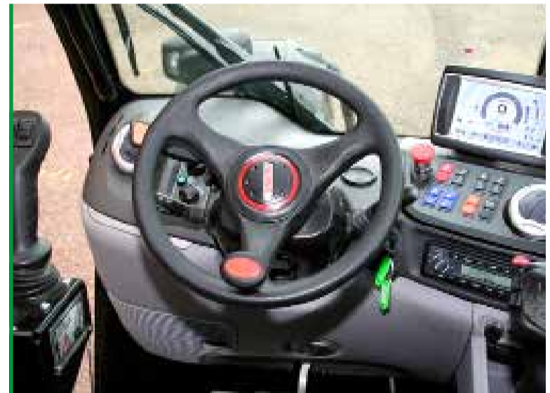
Les commandes ont été déportées sur un accoudoir à gauche, pour que l'éleveur puisse y accéder facilement.
